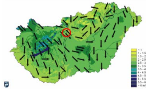
4.3. ábra: Az évi átlagos szélességek [m/s] és az uralkodó szélirányok Magyarországon (2000-2009) (forrás: www.met.hu)
